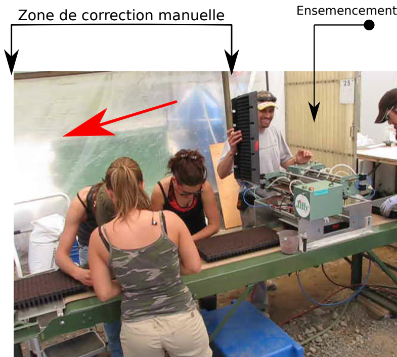
FIGURE 1.4 – Processus d'assurance qualité manuelle : les préposés à l'assurance qualité détectent les erreurs par la vue.
